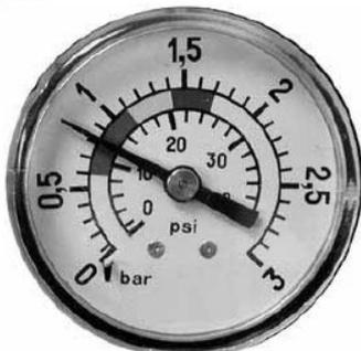
**0,8 kg/cm<sup>2</sup> - 11,4 PSI:** Anfangsdruck eines Filters zu Beginn eines Filterzyklus
