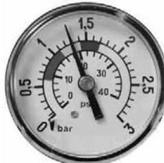
**1,3 kg/cm<sup>2</sup> - 18,5 PSI:** Der Druck beträgt 0,5 kg/cm<sup>2</sup> mehr als der Anfangsdruck. Das bedeutet, dass eine REINIGUNG notwendig ist.
