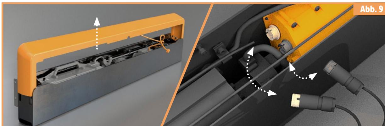
Schieben Sie die obere Abdeckung nach oben und trennen Sie die Anschlüsse des Solarmoduls (beige) und der LED-Anzeige (dunkelgrau) von dem Steuergerät. ACHTUNG! - Am Stecker, nicht am Kabel ziehen. Das Kabel könnte beschädigt werden. Bewahren Sie die Abdeckung und den Akku an einem sicheren Ort auf, um Beschädigungen bei der späteren Handhabung zu vermeiden.
