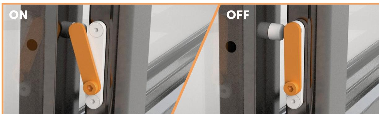
Die Riegel müssen verriegelt sein (= Position ON), damit der MOOVER ordnungsgemäß funktioniert.
