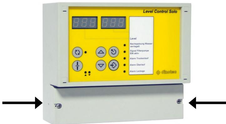
Schrauben Sie mit einem üblichen Kreuzschlitzdreher bis Größe 2 die untere graue Gehäuseabdeckung ab. Die beiden Schrauben sind im Deckel fixiert und können nicht herausfallen.
