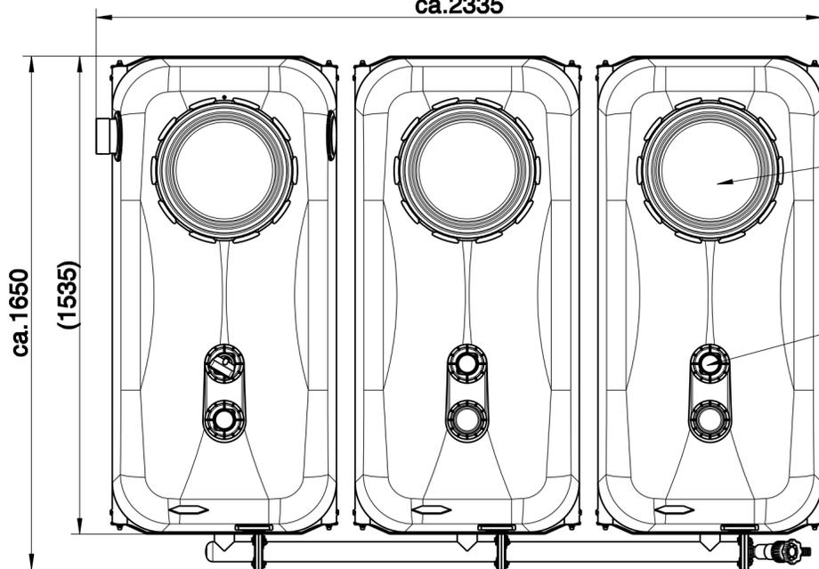
Revisionsöffnung  $\varnothing$  400mm mit Sicherungsdeckel
