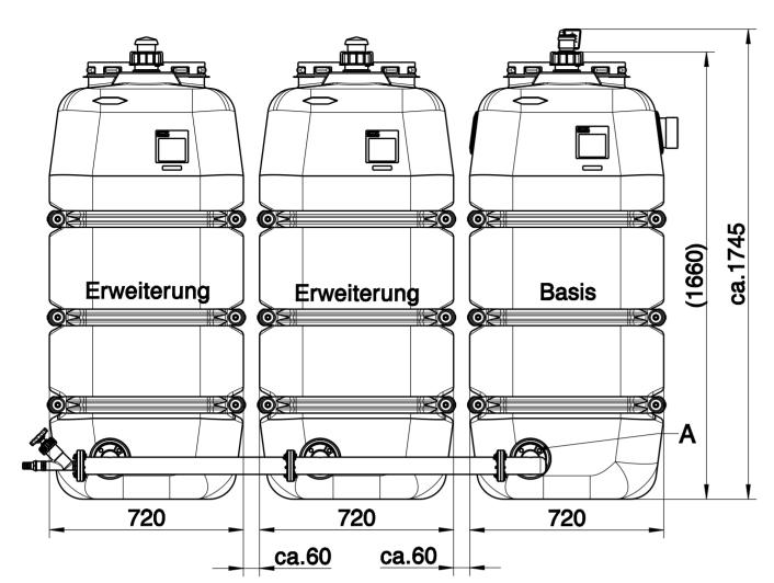
Bei Verwendung anderer Verbindungssysteme kann der Behälterabstand variieren!
