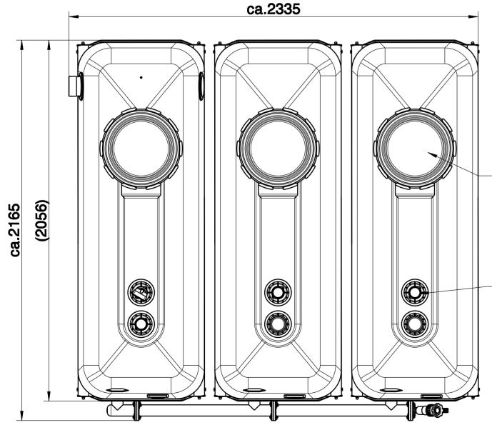
Revisionsöffnungen Ø 400mm mit Sicherungsdeckel
