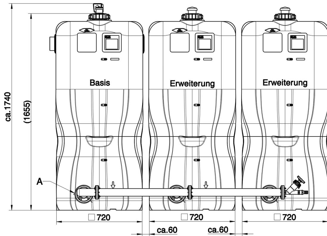
Flanschverbindung verschraubt mit eingelegter Dichtung
