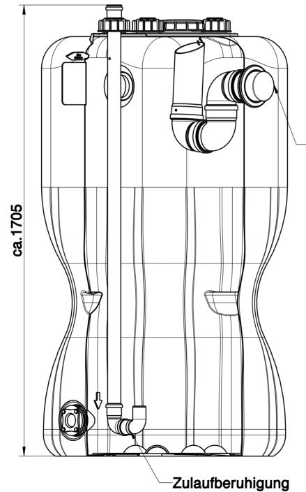
Anschluss DN 110optional für - Zulauf - Überlaufsiphon DN 110 mit Kleintiersperre Flanschanschluss zur optionalen Erweiterung mit Anschlusszubehör für Basis-Hausspeicher (Mat.-Nr.1115001287) Anschluss optional für - Flansch mit Kugelhahn (Mat.-Nr.1135005456) - Roth PP-Flansch 1" (Mat.-Nr.1135000156) - Roth PP-Flansch 2" (Mat.-Nr.1135000157) 135 130 □ 720
