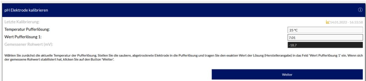
[Eingabefelder für den 1. Schritt der pH Elektrodenkalibrierung]
