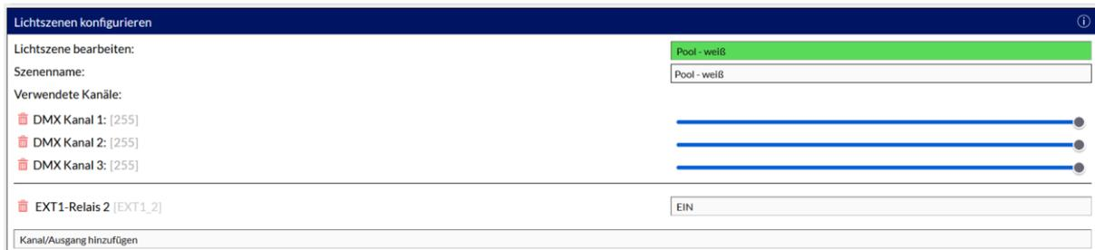
In der obigen Abbildung sind für die Szene „Pool – weiß“ die DMX Kanäle 1, 2 und 3 selektiert (und zusätzlich das Relais 2 der Relaiserweiterung). Die drei DMX Kanäle sind jeweils auf 100 % (Kanalwert 255) eingestellt. Welche Kanäle für die Lampe ausgewählt werden müssen, hängt immer von deren Adressierung ab. Diese ist teilweise
